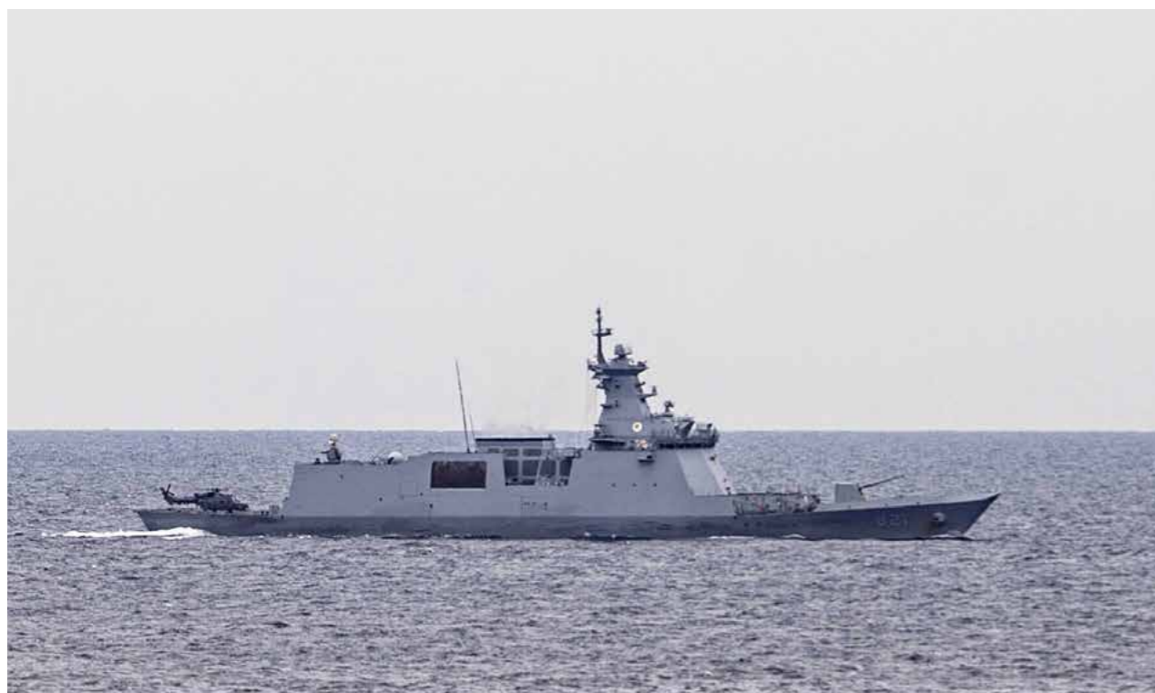
Фрегаты серии FFX-II ВМС Южной Кореи являются носителями крылатых ракет Haeseong, предназначенных для поражения береговых целей
